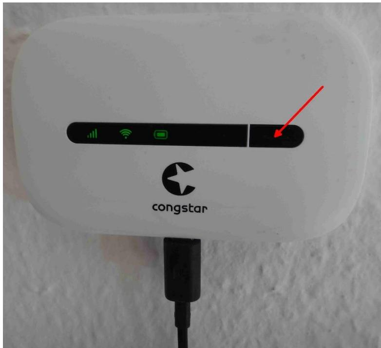
Sollten die Anzeigen nicht wie hier abgebildet leuchten, den Taster (Pfeil) drücken, bis das Gerät neu startet. Das Gerät verfügt über eine Handybatterie und funktioniert daher auch für einige Zeit, wenn es nicht mit dem Stromnetz verbunden ist.
